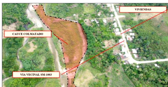
FIGURA N°03: SE OBSERVA VIVIENDAS CERCANAS AL CAUCE DEL RIO, LAS CUALES SON AFECTADAS POR INUNDACION AL DESBORDARSE EL RIO EN MAXIMAS AVENIDAS.
